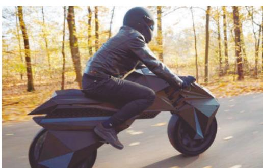
Protótipo funcional utiliza diferentes materiais para peças estruturais, pneus e carenagens Um meio de transporte pode ser feito exclusivamente com a técnica de impressão 3D? Sim, aparentemente. Isso é comprovado pela Nera, a motocicleta elétrica da BigRep que foi feita
